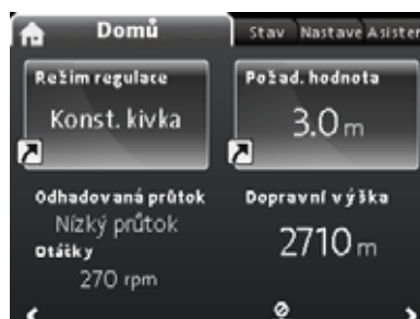
Obr. 63 Příklad: Parametry menu "Domů"
